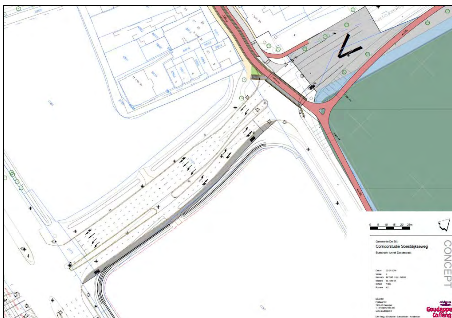
Figuur 4.9: Verruiming capaciteit aansluiting Utrechtseweg en verkeerskundige inpassing fietstunnel Dorpsstraat – Holle Bilt
