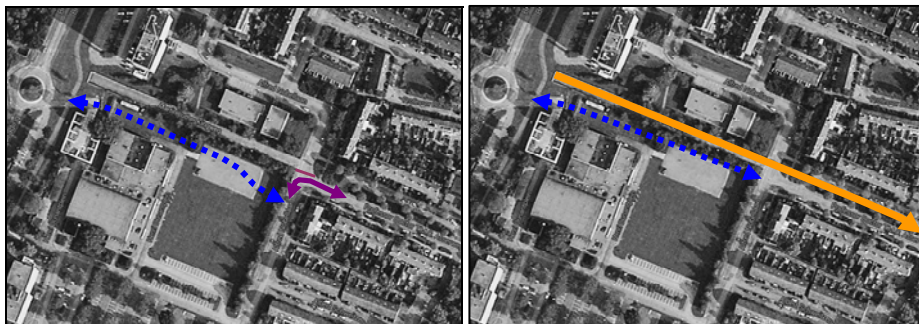
Figuur 4.6: Mogelijkheden ter aansluiting van het fietspad bij de realisatie doortrekking met (links) voorrangsbocht en (rechts) directe aansluiting fietspad in de voorrang
